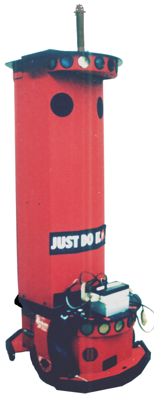
Abbildung 2.1: Der verwendete Roboter: Zu sehen sind ein Rad des Roboters, die beiden Sonarsensorarrays und der LOPS-Sender oben auf dem Roboter.
