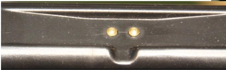
Muldenförmige Vertiefung im „Griffstück“ (am hintern Ende des Mähers) mit 2 Messingkontakten, die durch Regen leitend verbunden werden.
